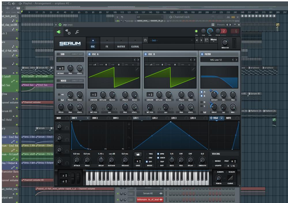
FIGURE 14 – Un synthé construit avec *Serum*, qui module le cutoff du filtre (section *FILTER*) avec l’enveloppe (section *ENV1*), dont la page de modulation est indiquée par la section bleue sur le potentiomètre *CUTOFF*
