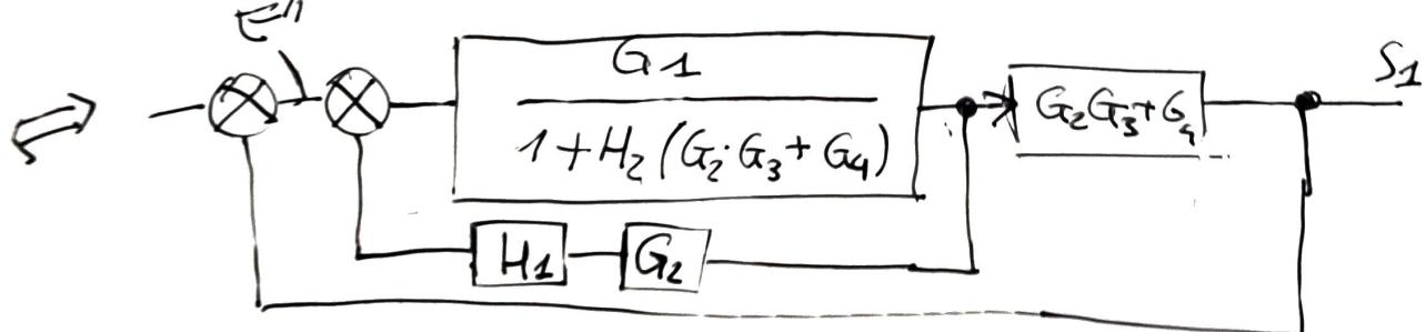
$$\frac{S_L}{E''} = (G_2G_3 + G_4) \frac{\frac{G_1}{G_1 \cdot H_1 \cdot G_2 + 1 + H_2(G_2G_3 + G_4)}}{G_1 \cdot H_1 \cdot G_2 + 1 + H_2(G_2G_3 + G_4)}$$
