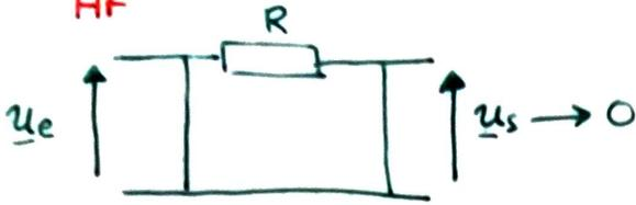
Le filtre RC laisse passer les basses fréquences et atténue les hautes fréquences
