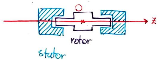
Une liaison pivot restreint les possibilités du mouvement du rotor par rapport au stator à une seule rotation.
