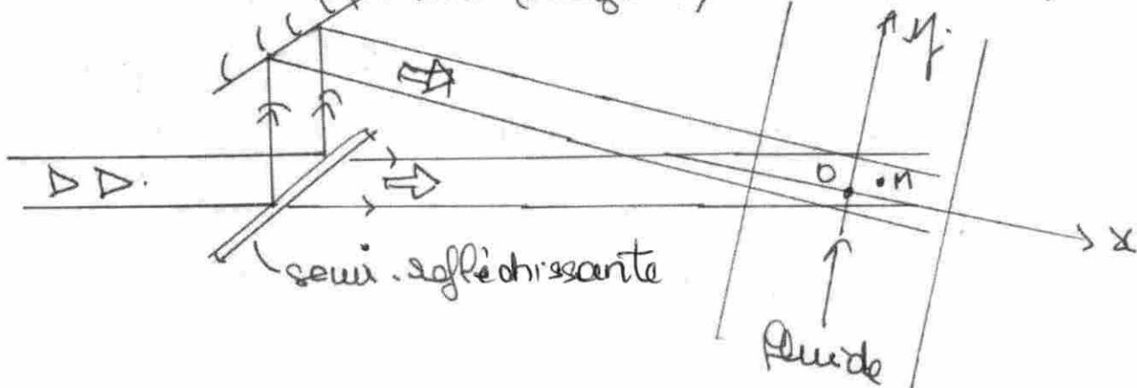
En ajoutant la longueur parcourue pour le faisceau 2 on peut se débrouiller pour que les 2 ondes soient en phase sur le plan  $y=0$ .
