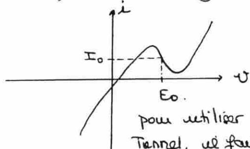
Pour utiliser l'effet Tunnel, il faut polariser la diode.
