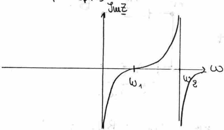
c) Si  $Z \rightarrow \infty$  = on peut avoir  $I=0$  (dipôle non connecté) et  $U$  aux bornes  $\neq 0$ . Alors la pulsation est  $\omega_2$  = pulsation d'oscillation du quartz.
