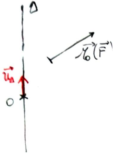
$$\mathcal{M}_\Delta(\vec{F}) = \text{projection sur } \Delta \text{ de } \vec{M}_O(\vec{F})$$
