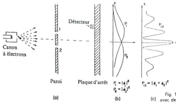
Fig. 1-3. Expérience d'interférence avec des électrons.
