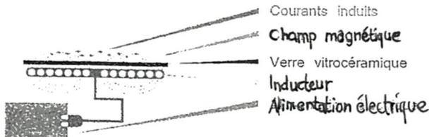
Ce bobinage est soumis à une tension d'alimentation  $v_1(t)$  sinusoïdale de valeur efficace  $V_1=130V$  et de fréquence  $f_1=25$  kHz. Le transfert d'énergie électrique s'effectue par induction mutuelle entre ce bobinage (l'inducteur) et la plaque circulaire du fond du récipient (l'induit) assimilable à une spire unique fermée.
