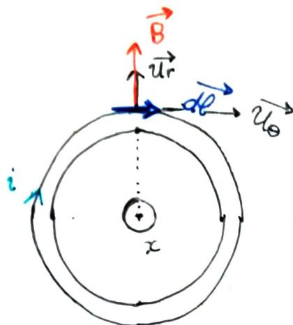
⚠  $\vec{F}_L \neq i \vec{M} \vec{N} \wedge \vec{B}$  car  $\vec{B}$  pas rectiligne!
