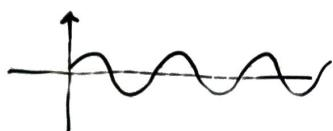
Si on veut sélectionner l'harmonique  $f_k = kf_0$ , on envoie le signal d'un passe-bande de fréq  $f_c = f_k$ .
