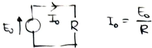
La puissance délivrée par le générateur et reçue par la résistance :  $P = E_0 I_0 = \frac{E_0^2}{R}$
