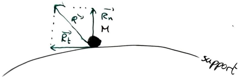
**Réaction** force exercée par le support sur M:  $\vec{R}$
