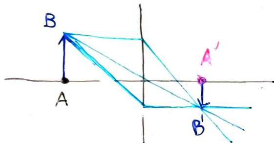
On associe à  $A$  un point  $B$ , on construit l'image  $B'$  et par aplana&gt;tisme, on trouve  $A'$
