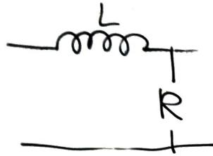
$$\underline{H} = \frac{1}{1+j\frac{\omega}{\omega_0}} \quad \text{avec } \omega_0 := \frac{R}{L}$$
